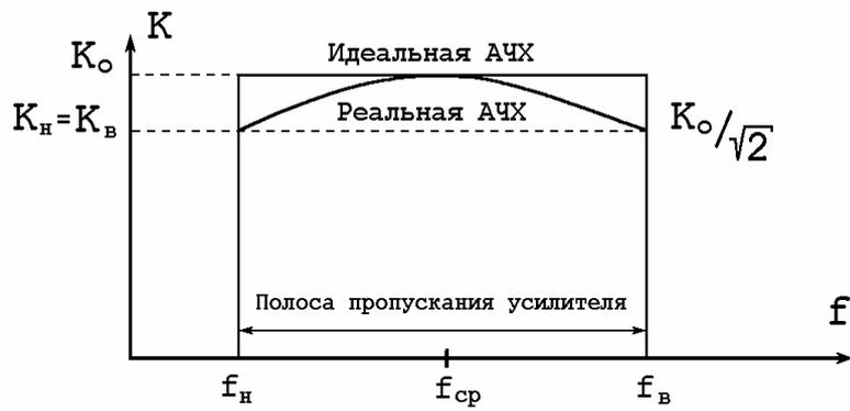
Рис. 3. Амплитудно-частотная характеристика усилителя.
