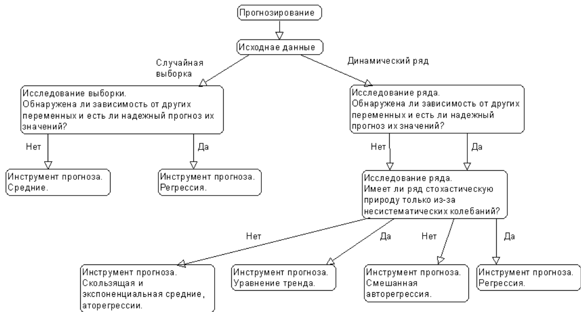
Рис. 2.6. Схема выбора метода прогнозирования
